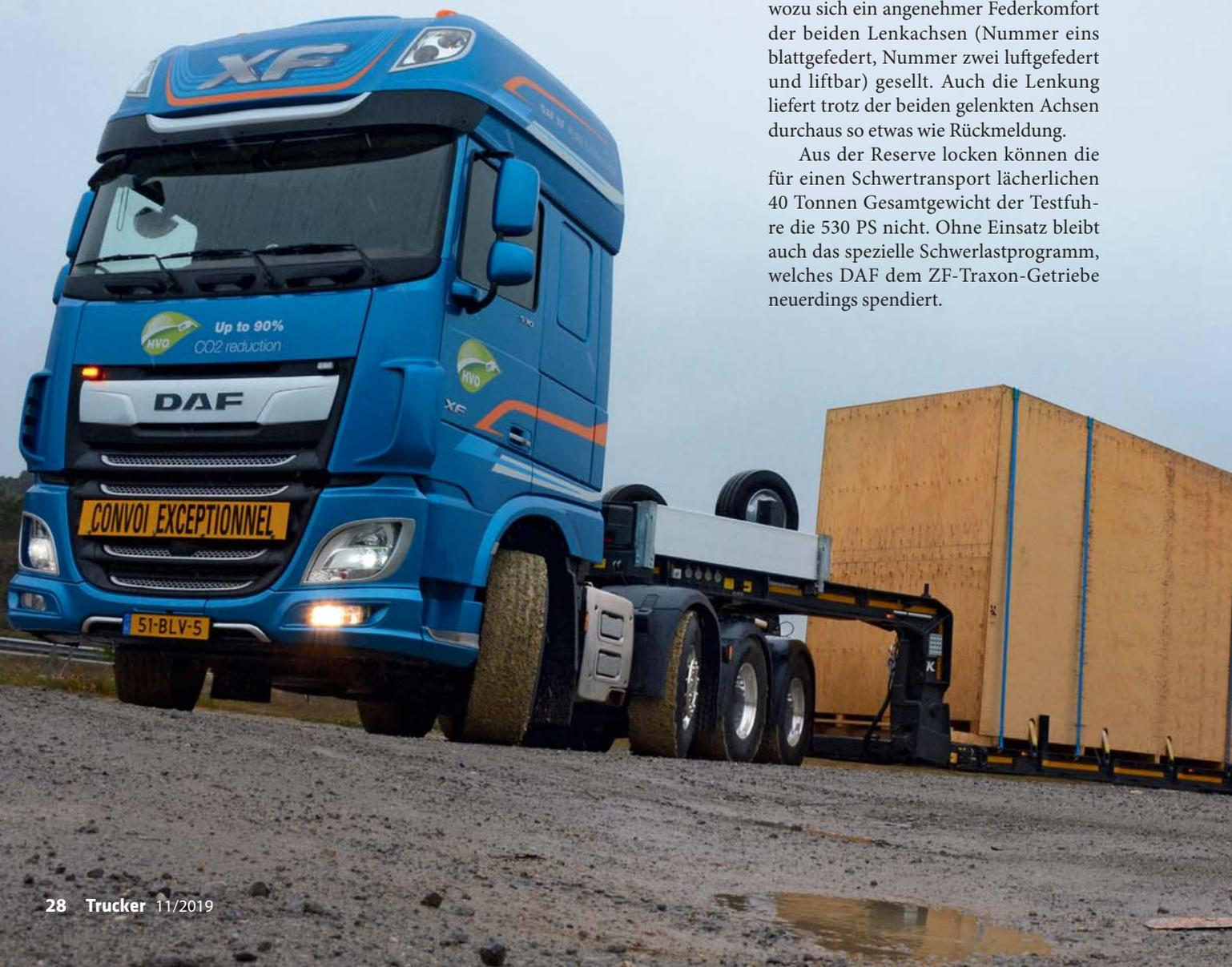
Nicht minder unterfordert ist die kräftige und harmonisch gesteuerte Kombination aus MX-Motorbremse und ZF-In-tarder. Bei Ausreizung der vollen 80 Tonnen dürfte ihre kombinierte Bremsleistung deutlich gefragter sein.
